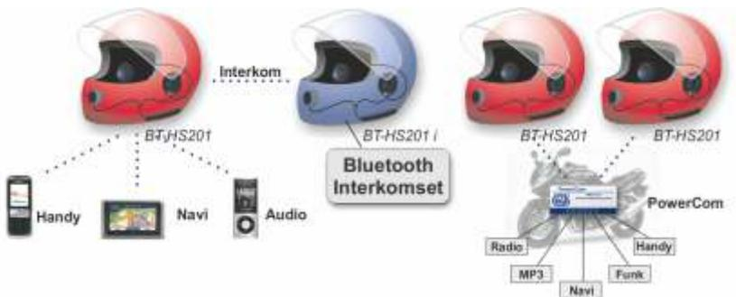
Das Stealth-Bluetooth-Helmset 201 kann mit allen Bluetooth-Geräten betrieben werden, die das A2DP, das Handsfree- oder das Headsetprofil unterstützen, z.B. mit Bluetoothfähigen Handys, Navigationsgeräten, MP3-Playern sowie mit allen Motorradkommunikationssystemen und Freisprecheinrichtungen der **AKE PowerCom** - Serie mit Bluetooth-zum-Helm-Unterstützung.
