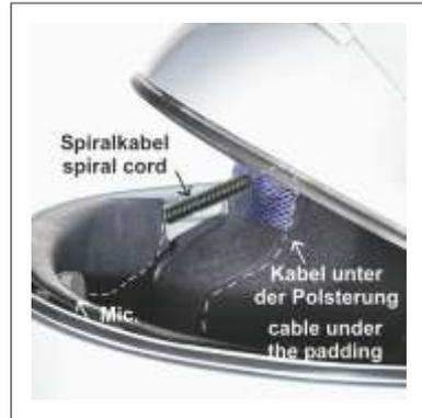
Dieses können Sie so verlegen, dass die elastische Spirale die Verbindung zwischen den beweglichen Helmteilen herstellt, fixieren Sie dabei die Spirale so, dass das Kabel bei geschlossenem Helm nicht gequetscht wird.
